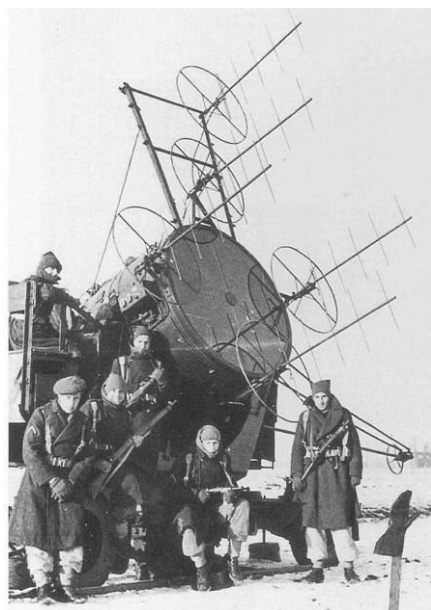
3.13. Opsporingszoeklicht met primitieve radar. (Herkomst: YL.)
